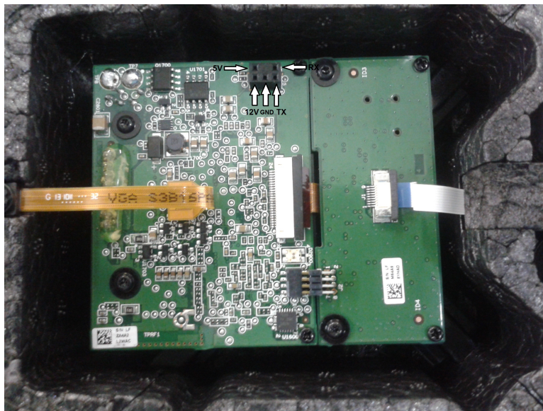
Figura 6.3: Mapa de pinos na placa interna do AR.Drone
