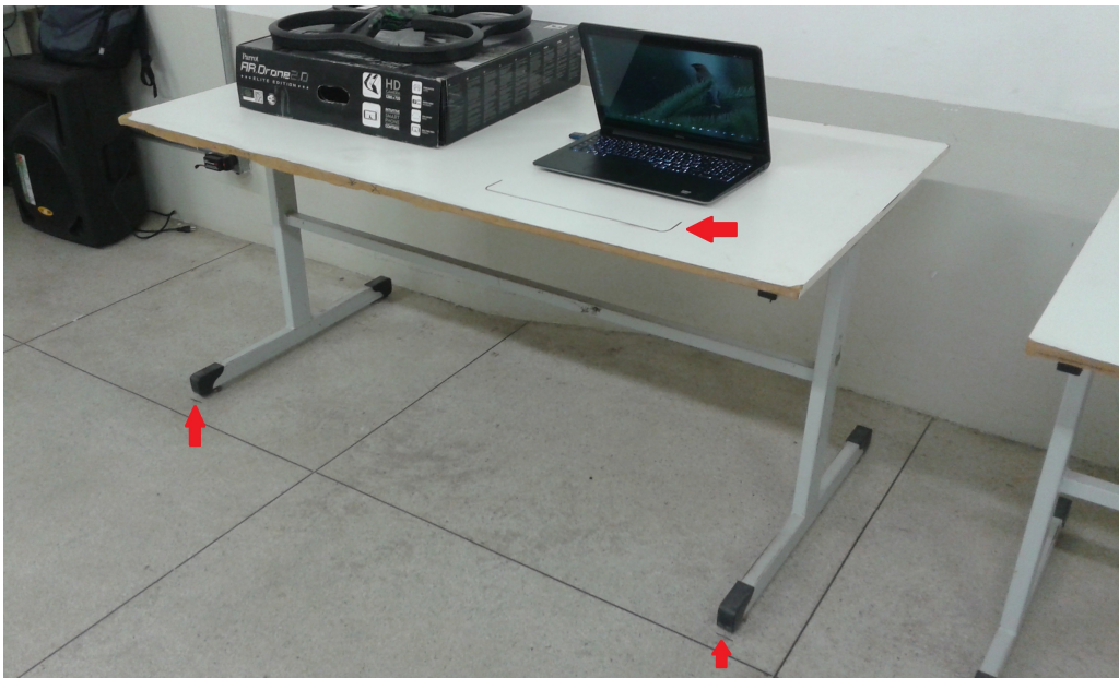
Figura B.2: Marcações para manter o posicionamento fixo da bancada e notebook.
