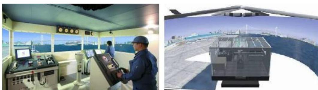
Figura 4. Simulador para situações de risco em navegação
