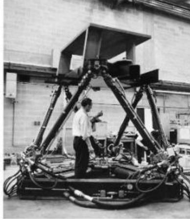
Figura 1. Primeiro modelo de simulador construído com arquitetura hexápode
